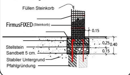
Korb mit gewünschtem Material füllen. Für eine gute Verteilung sorgen. Die Distanzhaken vorübergehend mit einem kleinen Balken schützen, um Schäden beim Füllen zu verhindern.
