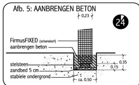
Beton bis 3 cm unter Geländeoberkante anbringen.
