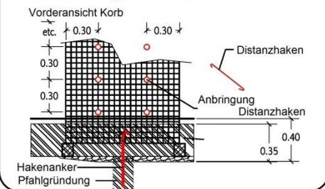
Bei Steinkörben mit einer Höhe von 200 cm, müssen 10 Distanzhaken an den in der Zeichnung angegebenen Stellen angebracht werden. Die Anbringung der Distanzhaken mit dem Füllen der Körbe kombinieren.
