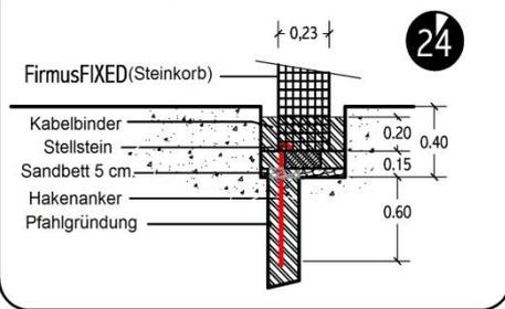
Anbringung vertikaler Pfähle zum Erschweren und Stabilisieren der aufzustellenden Körbe. Ungefähr in der Mitte jedes Korbes eine Aussparung im Graben anbringen: - Tiefe ca. 60 cm,  $\varnothing$  ca. 15 cm
